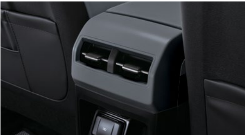
Ventilador da consola central traseira
