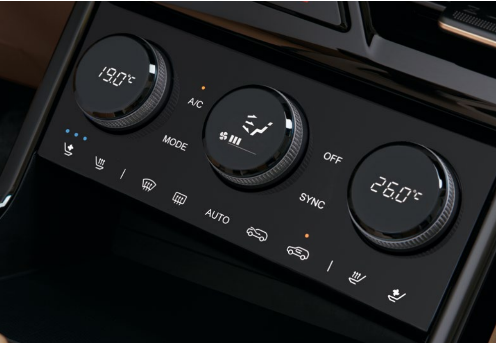
Ar condicionado automático de duas zonas com botão rotativo
