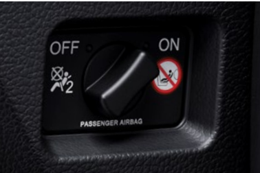
Interruptor de ativar/desativar o airbag do passageiro
