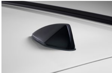
Antena tipo barbatana de tubarão com Glonass, DAB e GSM
