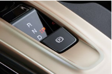
Travão de mão elétrico com função de imobilização automática
