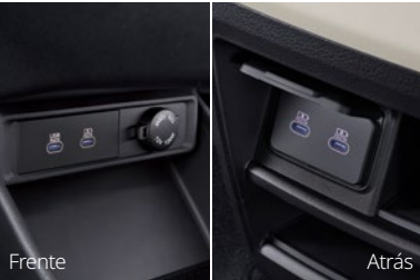
Tomadas elétricas de 12 V e carregadores USB-C de 27 W à frente e atrás
