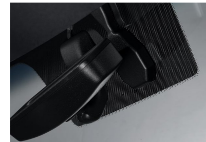
Módulo da câmara frontal com sensor de chuva e controlo automático dos faróis
